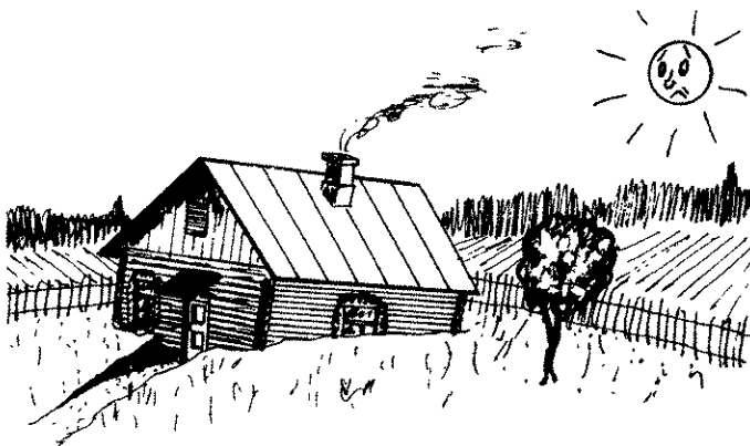
Рис. 179. Дом на вечной мерзлоте может провалиться при плохой теплоизоляции пола
