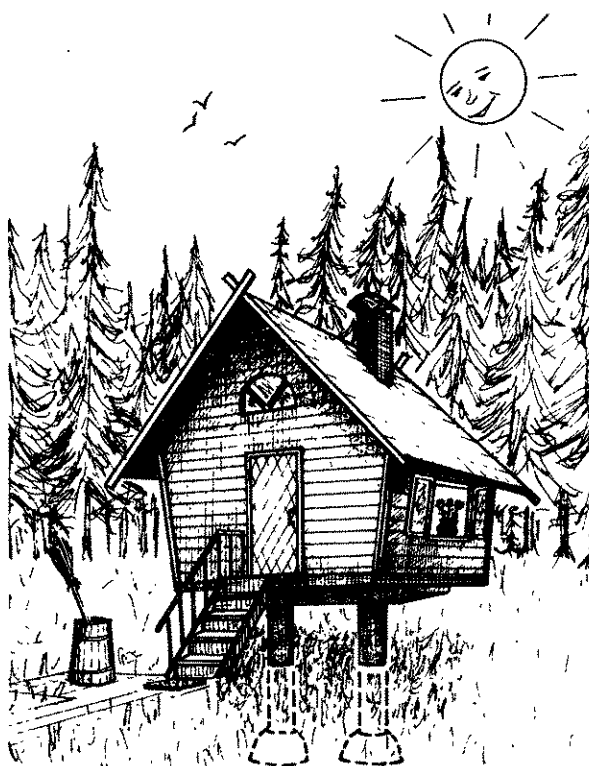
Рис. 128. Две опоры ТИСЭ способны выдержать вес небольшого дома
